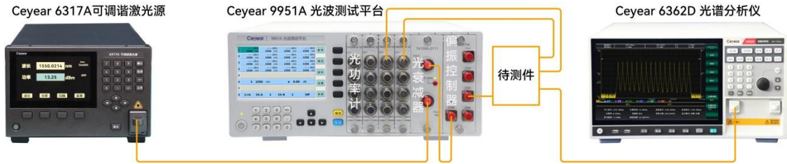
图 2.3 6317A 可调谐激光源用于通用光电器件特性测试
