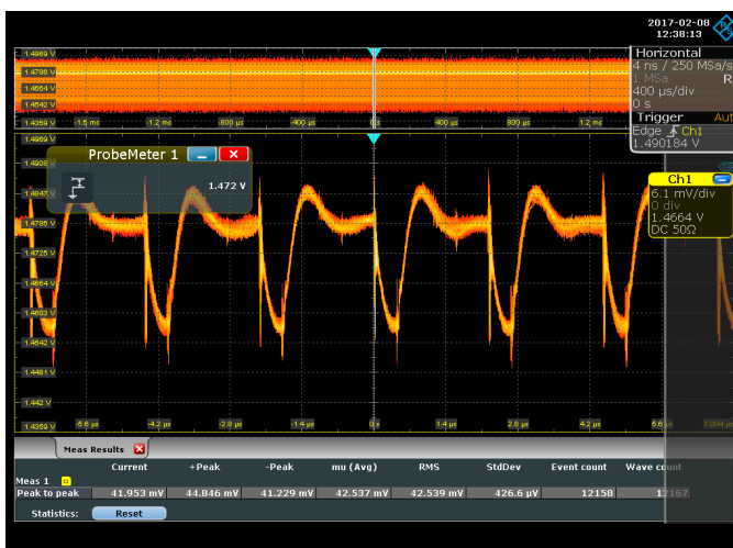
在DDR存储器初始化期间使用R&S®RT-ZPR电源完整性探头及其集成式高精度R&S®ProbeMeter准确验证直流电平以及电源负载响应
