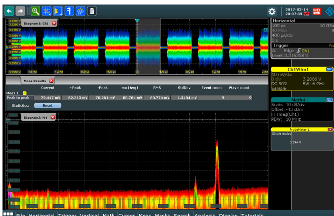
R&S®RT-ZPR电源完整性探头具备高带宽，有助于捕获高频噪声分量
