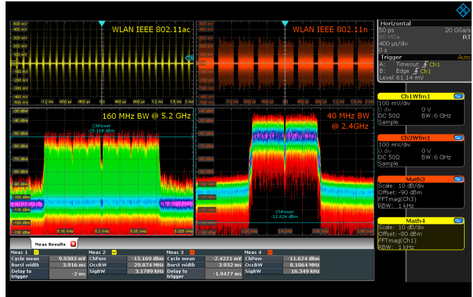
R&S®RTP针对WLAN IEEE 802.11n和11ac MIMO信号的多通道频谱分析
