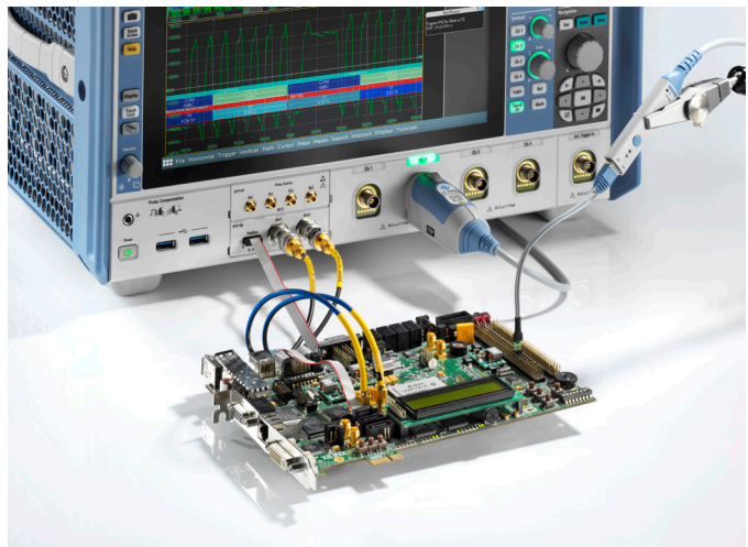
集成式任意波形发生器可用作时钟信号以测量LVDS信号，并使用八位码型发生器对设备进行编程控制
